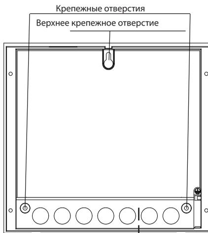
Отверстия для следующих проводов: Сетевая подводка; подводящий провод печи; подводящий провод испарителя лампы; вентилятор
