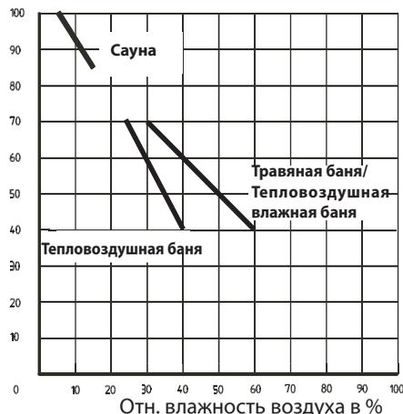
Отображенная на дисплее интенсивность влажности соответствует пропорциональной по времени настройке испарителя. Поэтому на дисплее предварительно задается или отображается не относительная влажность воздуха, а частота включения испарителя в процентах. График наглядно это показывает.
